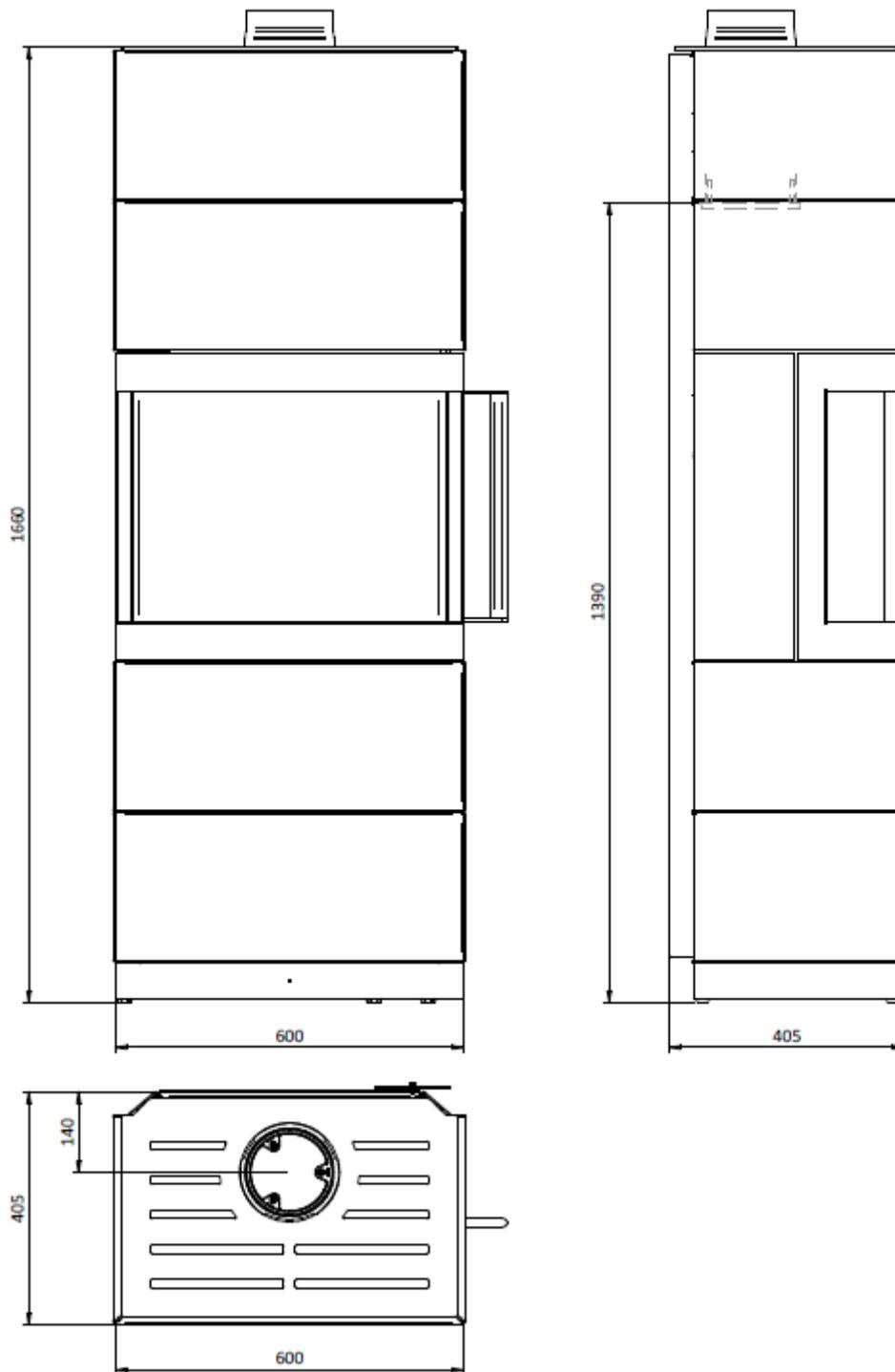
Raumluftunabhängige Feuerstätten mit den Bezeichnungen "SILA iQ", "SILA PLUS iQ", "LIMA iQ", "SILA iQ+", "SILA PLUS iQ+", "LIMA iQ+", "LHASA iQ" und "PATNA iQ"
