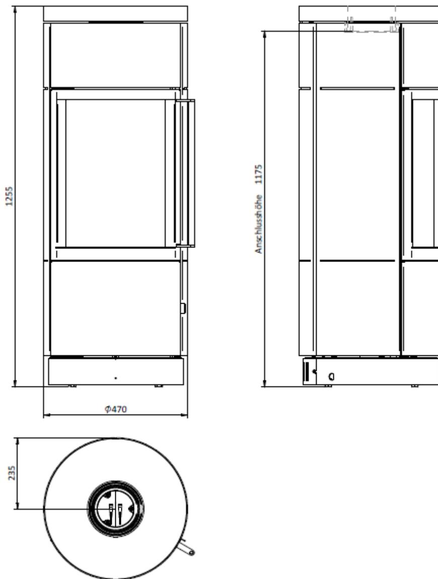
Raumluftunabhängige Feuerstätten mit den Bezeichnungen "SILA iQ", "SILA PLUS iQ", "LIMA iQ", "SILA iQ+", "SILA PLUS iQ+", "LIMA iQ+", "LHASA iQ" und "PATNA iQ"
